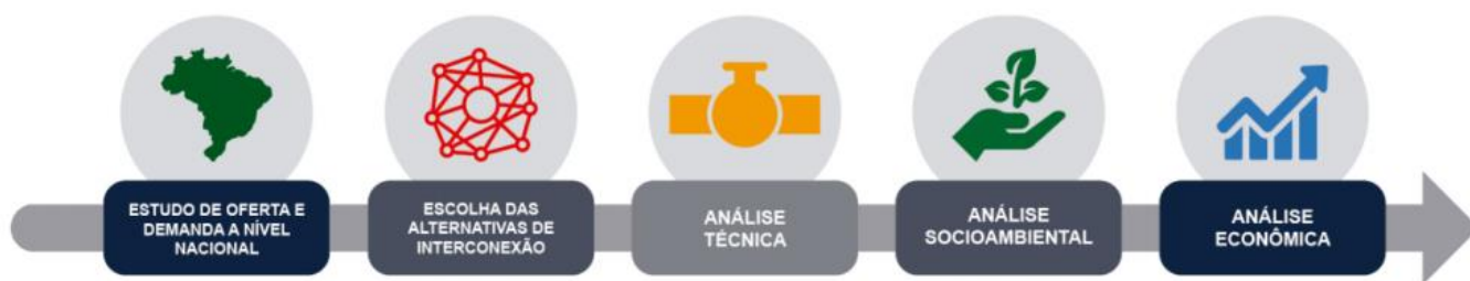
Figura 1. Metodologia de análise de alternativas para expansão da malha de gasodutos de transporte
